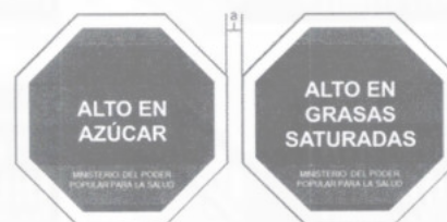
Diagrama N° 3. Rotulación con más de una figura octagonal y distancia entre figuras.
